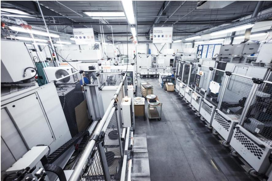
**Bildtext:** Die Firma Schäffer setzt in ihren Fertigungshallen unter anderem Produktionslinien mit den Vollmer Modellen CHF und CHD ein, mit denen sich hartmetallbestückte Kreissägeblätter präzise in einer Aufspannung schärfen lassen. (Foto: Schäffer)
